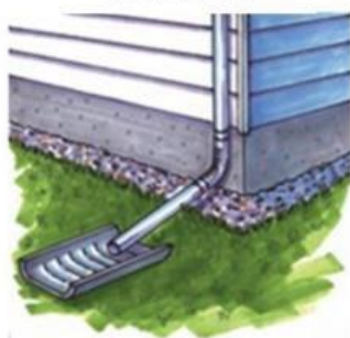
Un déflecteur en béton
