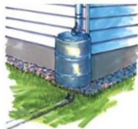
Un baril récupérateur avec un trop-plein
