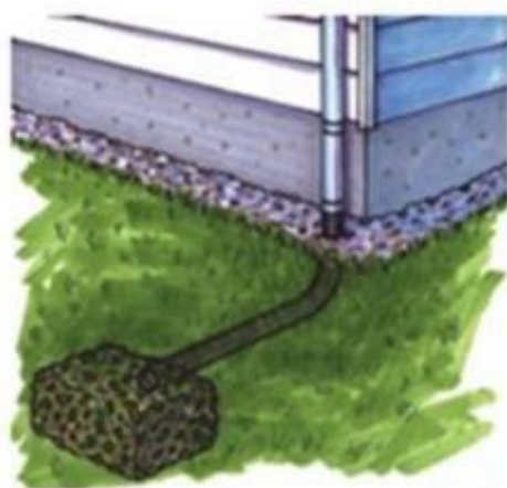
Un massif d'infiltration (éloigné d'au moins 2 m du bâtiment)
